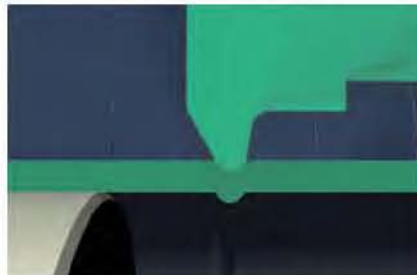
Sickenrollen zum Herstellen rinnenförmiger Vertiefungen.
